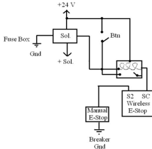
**Figure 17: E-Stop Wiring Diagram**
